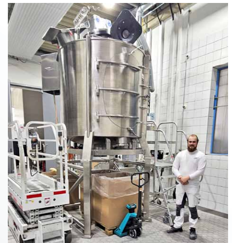
Gyraton® 试验混合机适用于最大 3 立方米的批量。气密、卫生、应用广泛。
